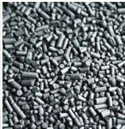
Die Aktivkohle in den CMS-Behältern bindet den Sauerstoff der Umgebungsluft, während Stickstoff den Behälter ungehindert passieren kann.
